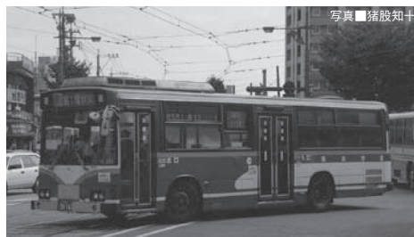
交通局は1990年代、新技術を盛り込んだ低床バスを積極的に導入した。写真は95年に導入したスロープ付きワンステップバス。97年にはノンステップバスも登場した
